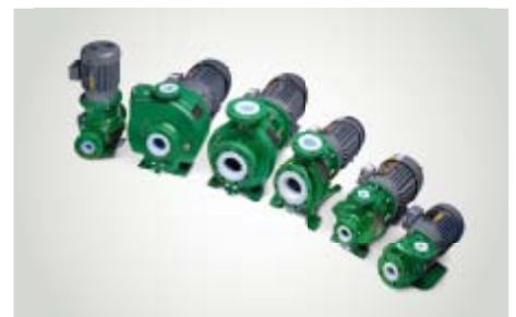
ANSIMAG Dichtungslose Pumpen mit Magnetkupplung Bei den Pumpen der Serie ANSIMAG K+ handelt es sich um magnetgekuppelte, dichtungslose Kreiselpumpen mit einer Förderleistung bis zu 160 m³/h, Förderhöhe bis zu 100 m und Temperaturen von -85°C bis 120°C.
