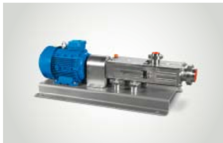
Pomac Edelstahl Doppelspindelumpen sind sehr flexibel und selbstansaugend. Für sensible Medien von dünnflüssig bis hochviskos mit Stückigkeiten bis 30 mm – als CIP- und Produktpumpe geeignet.
